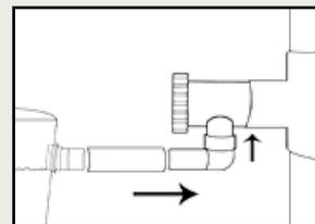
6. Placer le coude sur le robinet. Fixer l'embout à la cuve. Relier l'embout au coude avec le tuyau
