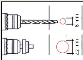
1. Percer un pré-trou de 8 mm (foret non fourni) qui servira de guide à la scie-cloche et faire le trou de 42 mm
