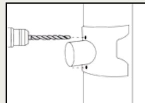
3. Placer le collier sur la gouttière et percer 2 trous (Ø 2 mm) aux emplacements prévus
